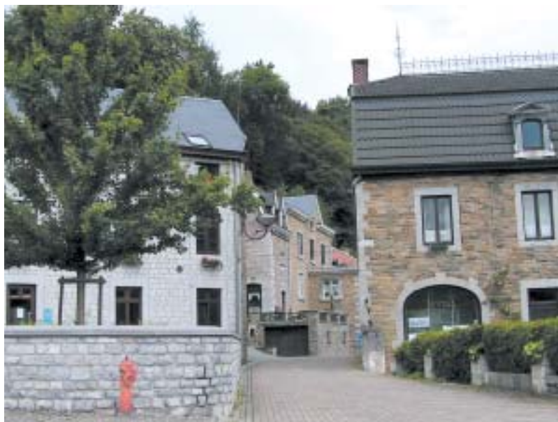
Photo II-1. La place Leblanc à Comblain-au-Pont. Façades en grès ou, pour les demeures patriciennes, en calcaire. Encadrements de fenêtres en calcaire «petit granit». Photo C.E.
