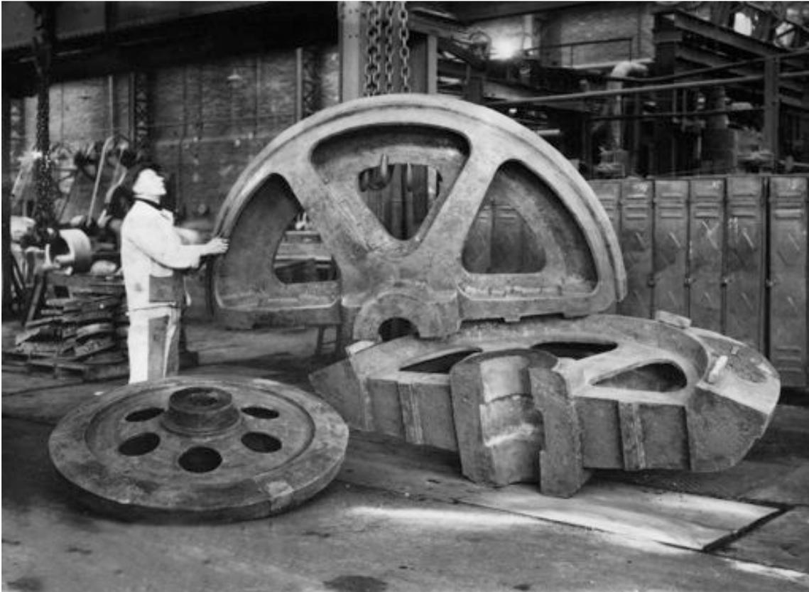
*Modèles pour engrenage conique en deux parties.*
